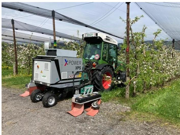
Fig. 1: Machine XPS adaptée en viticulture, testée en 2021 en arboriculture (XPO)
