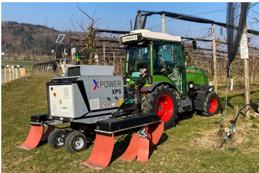
Mit dem XPower wird das Unkraut bis in die Wurzeln mit Strom vernichtet. Bild: Agroline
