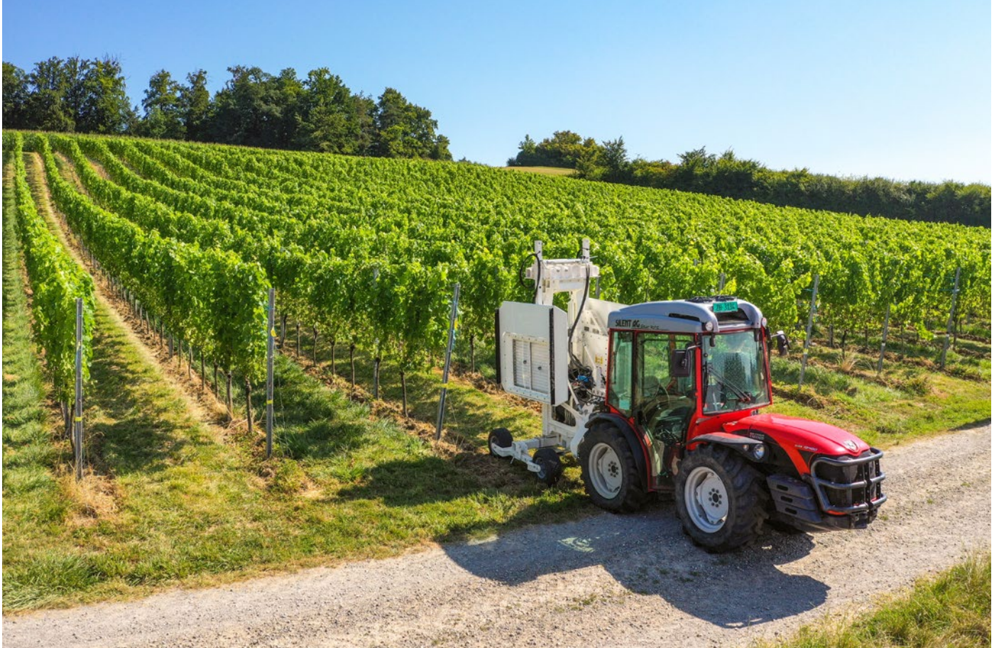
Mit dem UV-Boosting-Gerät werden die Pflanzen beidseitig der Reihe bestrahlt.
