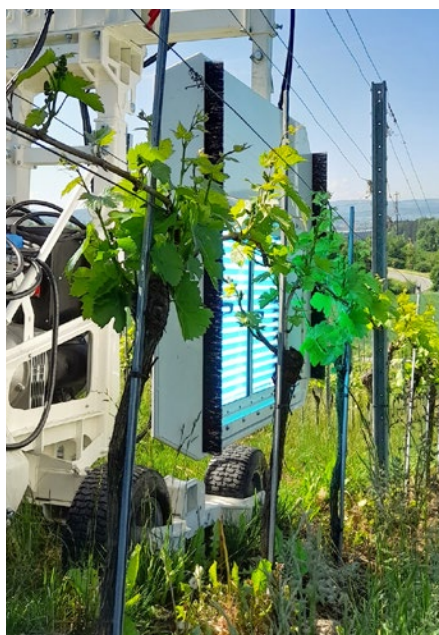
Eine Bestrahlung mit UV-C-Licht regt die Abwehrmechanismen der Pflanzen an.
