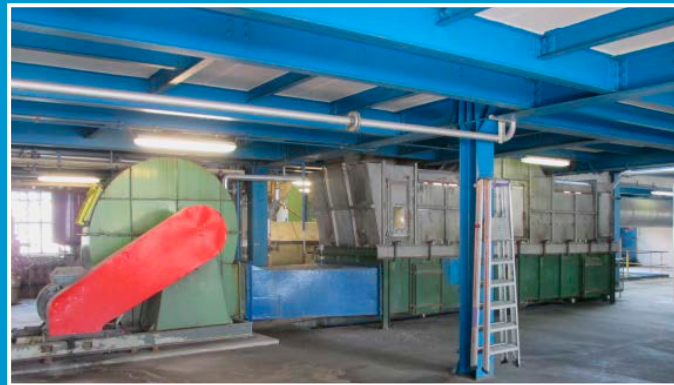
Nach der Granulation werden die Düngerkörner im Wirbelbettkühler gekühlt.
